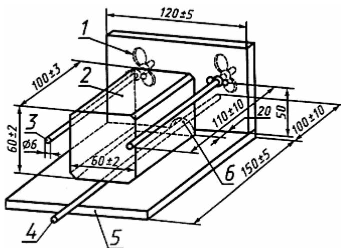
1 - фиксирующее устройство; 2 - алюминиевый блок; 3 - направляющий стержень;
