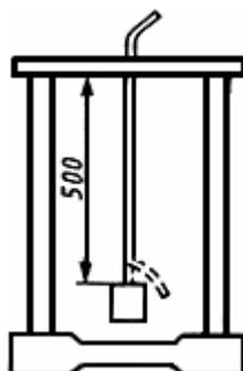
Рисунок 1 - Схема приспособления для испытания шнуров на растяжение
